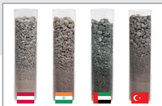
Ejemplos de mezclas de hormigón de 4 países (de izquierda a derecha): guijarros redondos de Austria, piedras partidas de India y Dubái, los aditivos de la muestra de Turquía, en el extremo derecho, son especialmente duros y de bordes muy afilados. Se pueden ver las curvas granulométricas de los aditivos de fino (abajo) a grueso (arriba).
